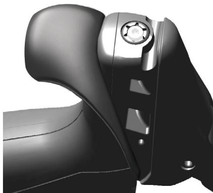
Przy pomocy klucza T10 TORX® odkręć śrubę portu odpowietrzania na dźwigni. Płyn wypłynie z portu odpowietrzania.
